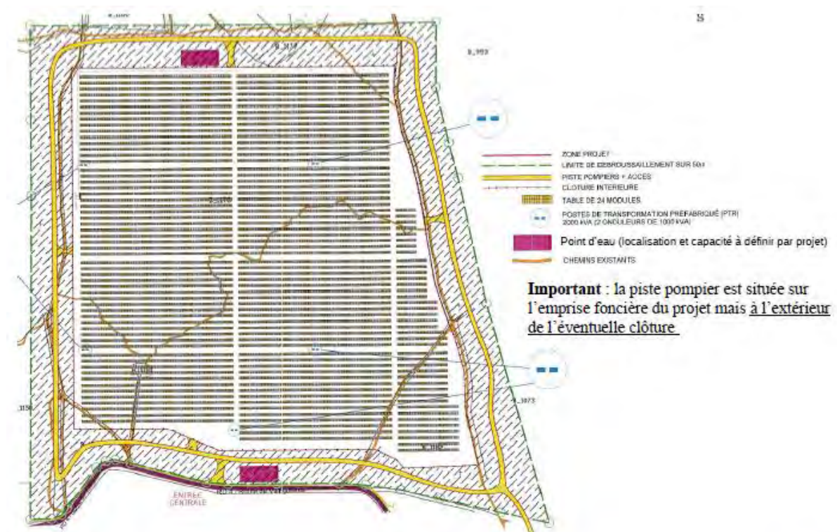
Schéma d'interface aménagée pour un projet de centrale photovoltaïque où la réalisation de la bande débroussaillée est assurée par l'application du débroussaillage réglementaire
